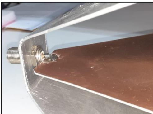
Figura 8 - Modificação realizada no septo após medidas com o TDR.
