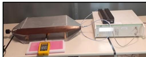
Figura 2 - Montagem de teste da célula TEM.
