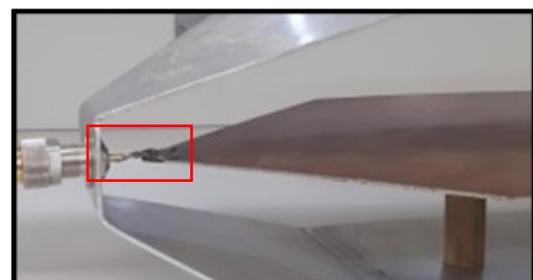
Figura 7 - Detalhe do aspecto construtivo do septo da célula antes das melhorias realizadas na célula TEM.
