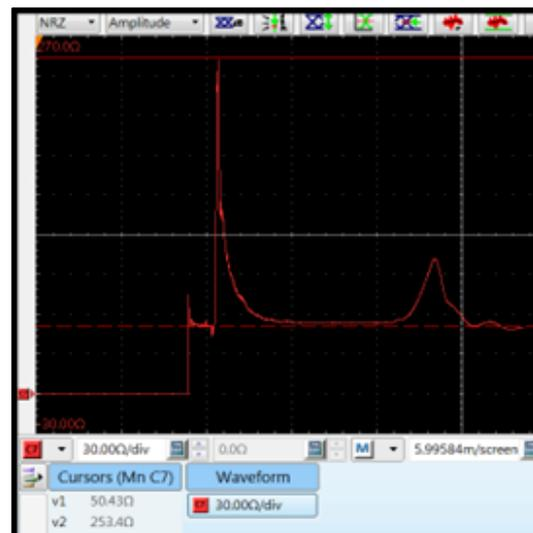
Figura 6 – Impedância ao longo da célula.
