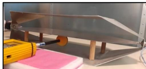
Figura 3 - Detalhe da medição de campo elétrico entre a base da célula e o septo.
